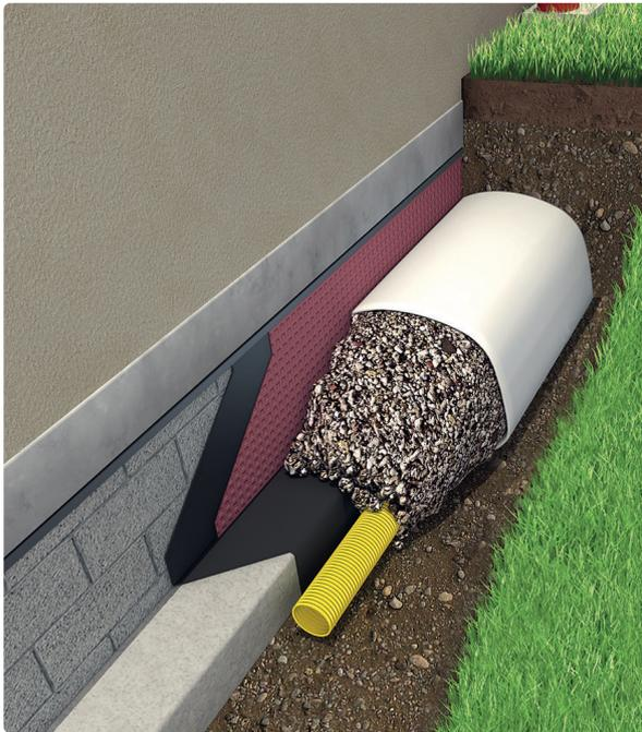
**Texto™ ist ein mechanisch vernadeltes Geotextil aus 100% Polypropylen-Endlofasern.**
